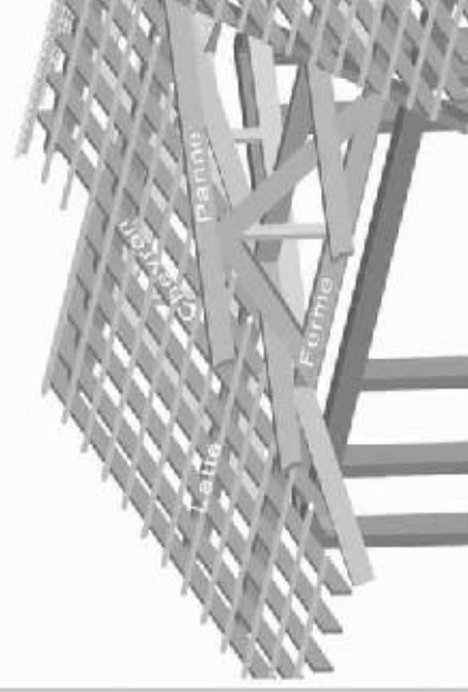
Structure d'une charpente classique
